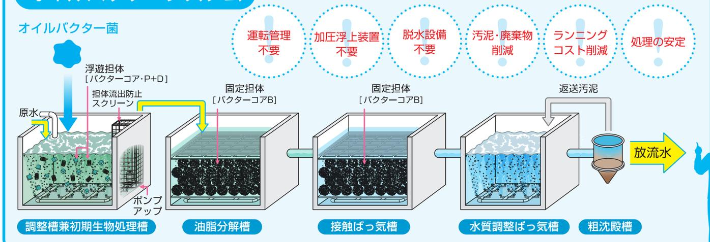
※原水水質及び放流基準値により沈殿槽、脱水設備等が必要な場合もあります。
